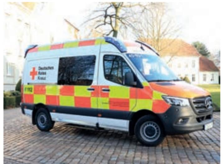
**Die Battenberg-Markierung:** Sie soll die Sichtbarkeit der Einsatzfahrzeuge erhöhen.
